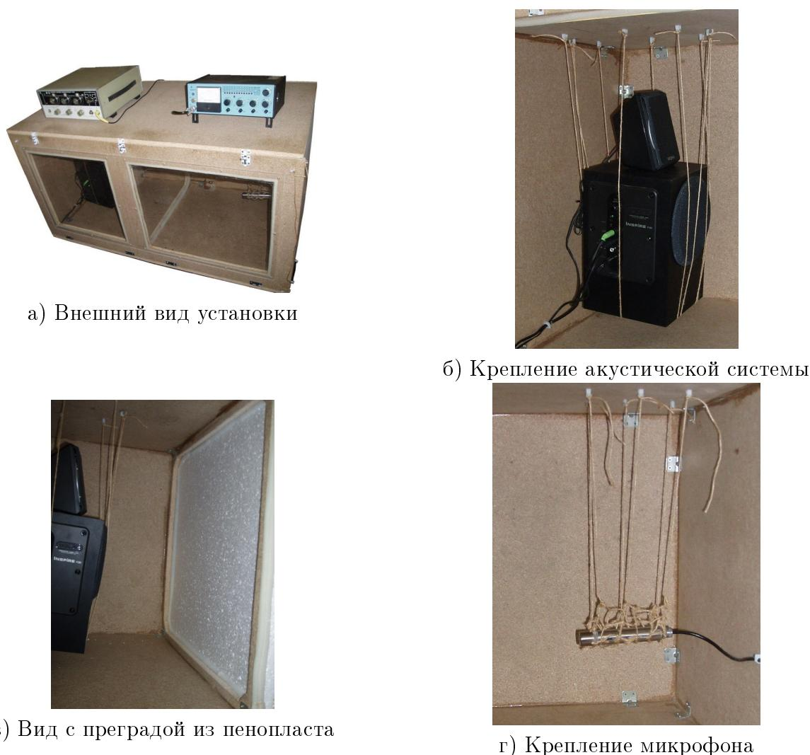
Рис. 3. Фотографические изображения установки
