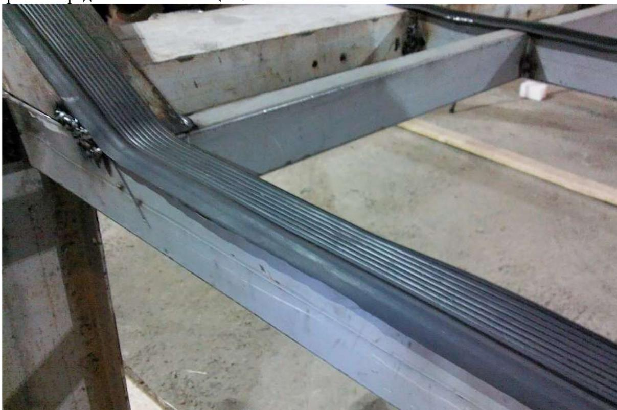
Рис. 3. Облицовка вибродемпфирующим материалом направляющих стенда
