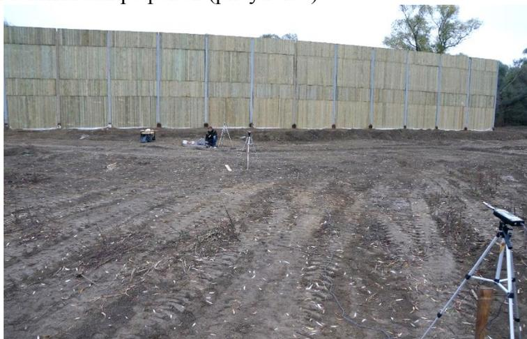
Рис. 7. Расположения измерительных точек для определения акустической эффективности шумозащитного экрана
