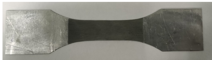
Рис. 3. Образец после лазерной обработки
