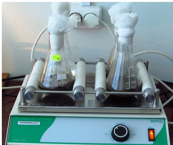
Рисунок 1 – Перемешивающее устройство с установленными колбами Эрленмейера, содержащими модельный раствор
