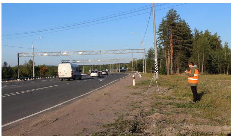
Рис. 1. Проведение измерений шумовой характеристики автотранспортного потока
