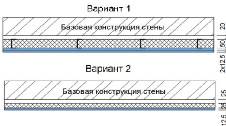
Рис. 1. Схема устройств дополнительной звукоизоляции базовой конструкции стены
