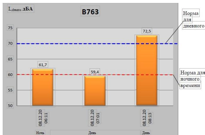
Рис. 10. Распределение  $L_{Amax}$  для аэробуса B763
