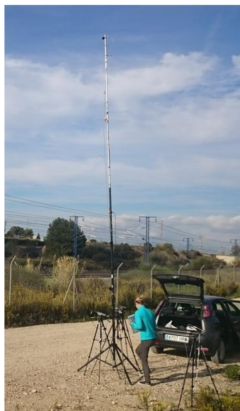
Рис. 1. а) схема измерений уровней звука на равнинной местности: 1 – подвижной состав, 2 – микрофоны; б) общий вид измерительной установки
