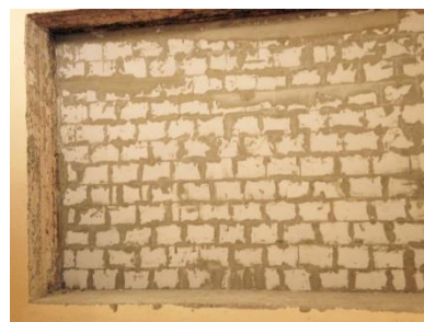
Рис. 2. Испытываемая конструкция из силикатных блоков
