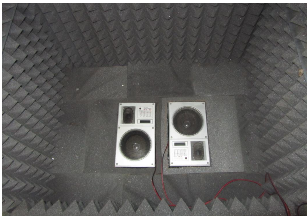
Рис. 3. Нижняя часть внутренней зоны камеры с акустическими системами
