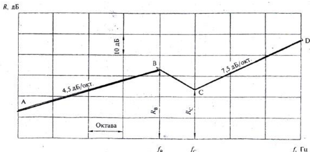
Рис. 1. Характерный вид кривой звукоизоляции тонких преград
