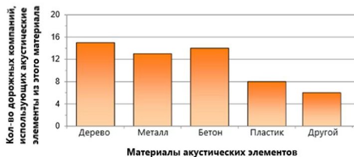
Рис. 4. Различные виды материалов используемые в шумозащитных экранах в разных странах
