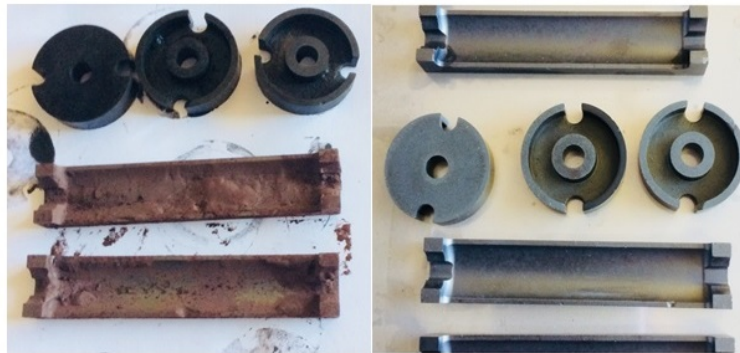
Рис. 3. Металлические изделия до и после очистки в УЗ ванне [13]
