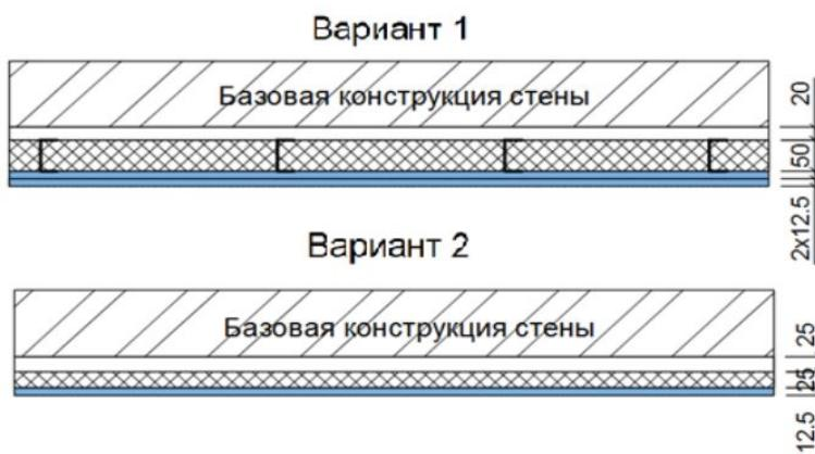
Рис. 1. Схема устройств дополнительной звукоизоляции базовой конструкции стены
