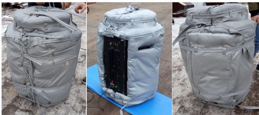
Рис. 2. Опытный образец термочехла (с открытым и закрытым технологическим окном)
